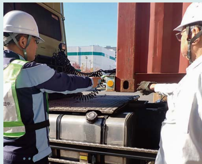
ロックピン施錠確認の様子
